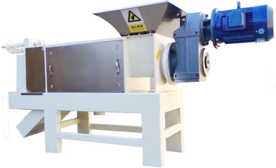
CT200 型螺旋压榨脱水机
